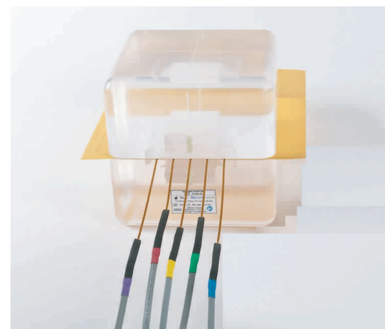
Un film placé entre les deux parties du fantôme utilisant les mosfet pour un plan IMRT
